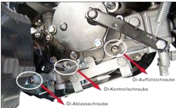
Versnellingsbakblok met olieregelpug, aftapplug en opblaasplug
